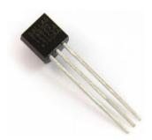
Fig. 3. Digital temperature sensor DS18B20 [10]
