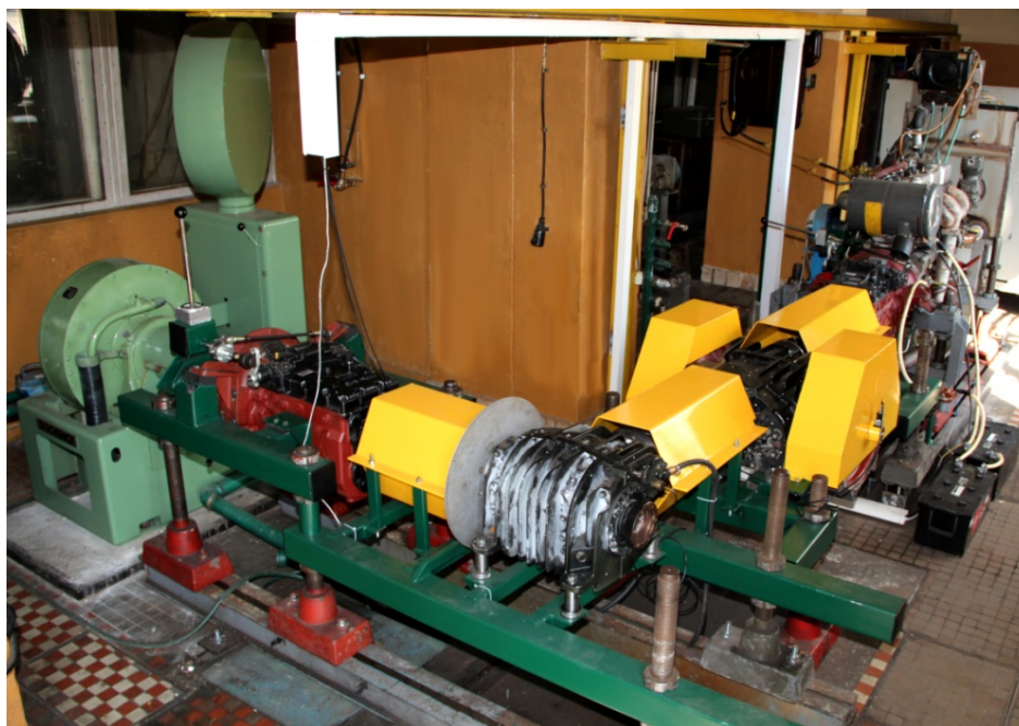
Fot. 1. Widok ogólny stanowiska badawczego przekładni głównych mostów napędowych KTO Rosomak
