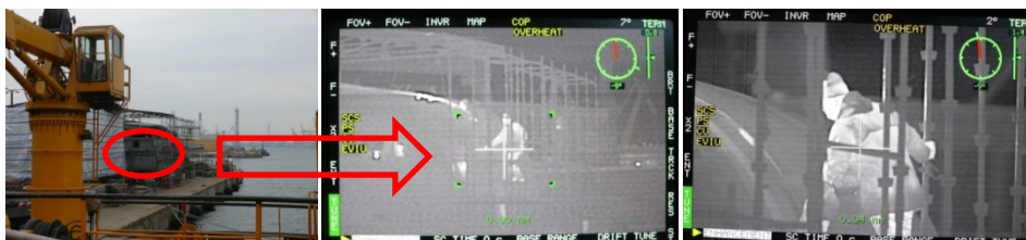
Rys. 10. Obraz widoku obiektu (pracownik na rusztowaniu) w skali normalnej, widok z kamery termograficznej i obraz z kamery termograficznej w powiększeniu maksymalnym
