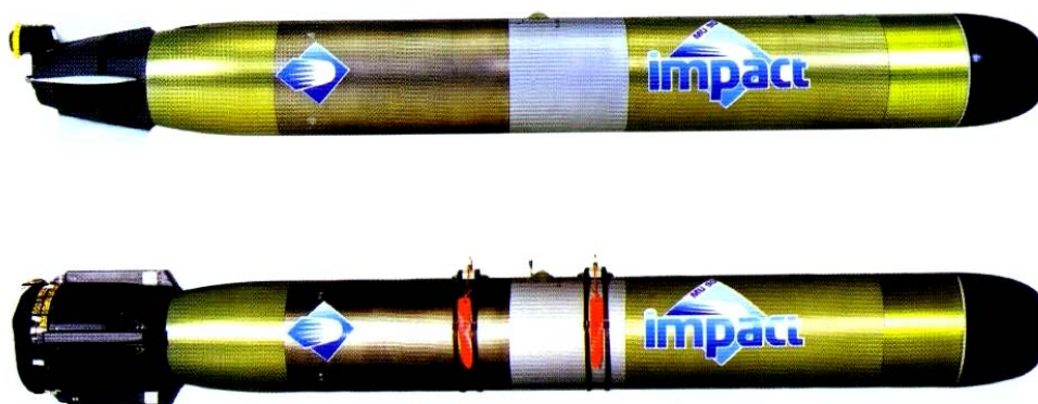
Rys. 2. Torpeda MU-90 Impact w wersji okrętowej (u góry) i w wersji lotniczej (na dole)
