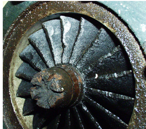
d) silnik czterosurowy M401A1 – deformacje wimika sprężarki
