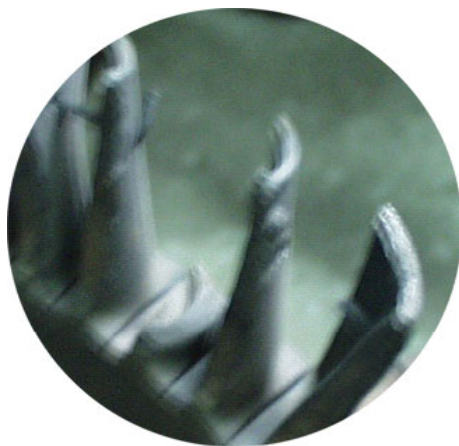
Rys. 2. Pęknięcie zmęczeniowe łopatki wirnikowej turbosprężarki
