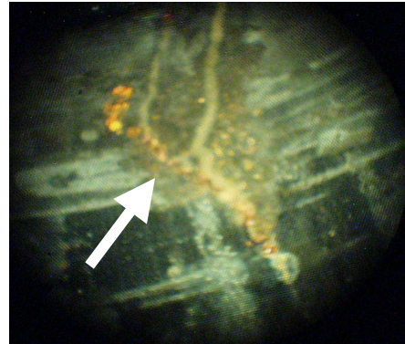
d) gładź tulei cylindrowej silnika M401A1 – pęknięta tuleja cylindrowa
