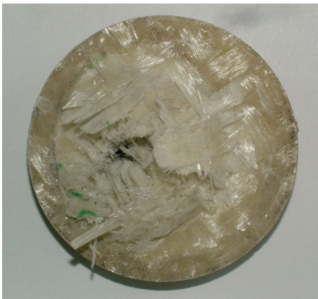
Rys. 3. Obszarowa delaminacja wzmocnień kompozytu poliestrowo-szklanego K zastosowanego jako 12 mm przekładki balistycznej po przebiciu pociskiem ŁPS 7,62 mm próbki dzielonej (2x6 mm) stopu AlZn5Mg2CrZr
