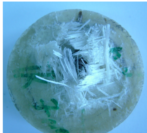
Rys. 3. Obszarowa delaminacja wzmocnień kompozytu poliestrowo-szklanego K zastosowanego jako 12 mm przekładki balistycznej po przebiciu pociskiem ŁPS 7,62 mm próbki dzielonej (2x6 mm) stopu AlZn5Mg2CrZr
