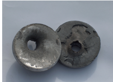
Rys. 2. Sposób penetracji (przebicia) próbki dzielonej (2x6 mm, części klejone żywicą) badanego stopu AlZn5Mg2CrZr pociskiem ŁPS 7,62 mm
