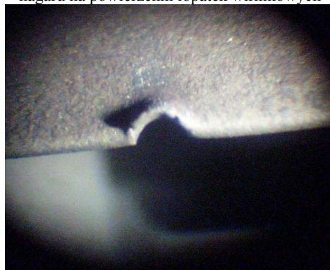
XVI st. sprężarki silnika LM-2500 – wgniecenie na krawędzi natarcia łopatki wirnikowej
