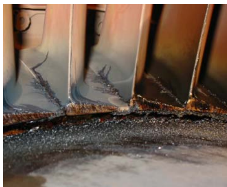
VI st. turbiny napędowej silnika LM-2500 – ślady nagaru na powierzchni łopatek wirnikowych
