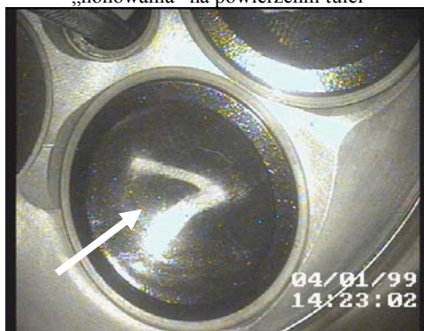
Zawory w głowicy silnika Mercedes MB620 – powierzchnie dolnej płyty głowicy wolne od zanieczyszczeń
