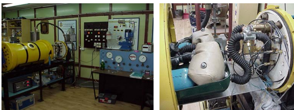
Rys. 1. Stanowisko badawcze symulatora oddechowego i metabolicznego: lewa strona – stanowisko zasilania i kontroli reaktora połączonego z symulatorem oddechowym; prawa strona – aparat nurkowy APW-6M podłączony do symulatora
